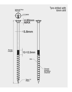
METAL DRILLING BUGLE BATTEN SCREW
